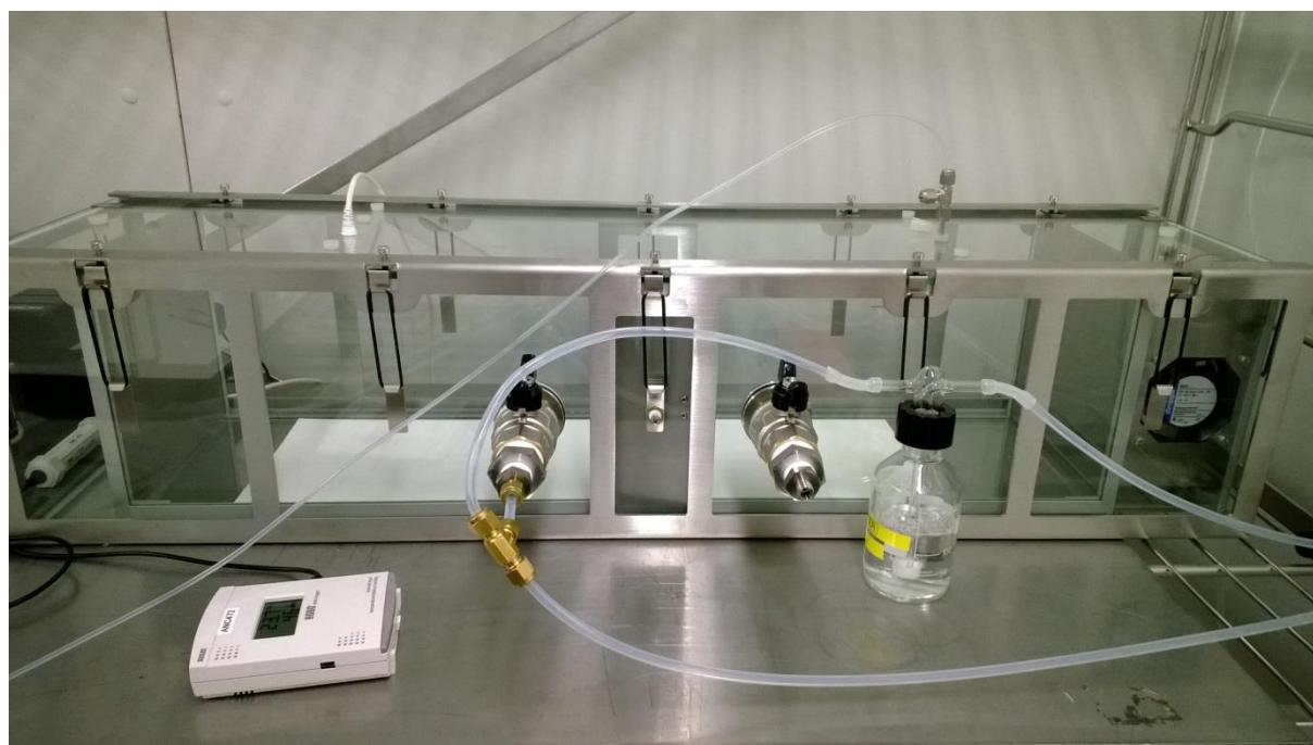
Figure 1. Plaques dans une chambre Climpack.
