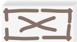
Par boudins discontinus lorsque les chevilles sont posées en plein et en joints, en laissant libre le pourtour de la plaque sur 2 cm afin d'éviter la pénétration de la colle dans les joints.
