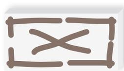
Par boudins discontinus lorsque les chevilles sont posées en plein et en joints, en laissant libre le pourtour de la plaque sur 2 cm afin d'éviter la pénétration de la colle dans les joints.
